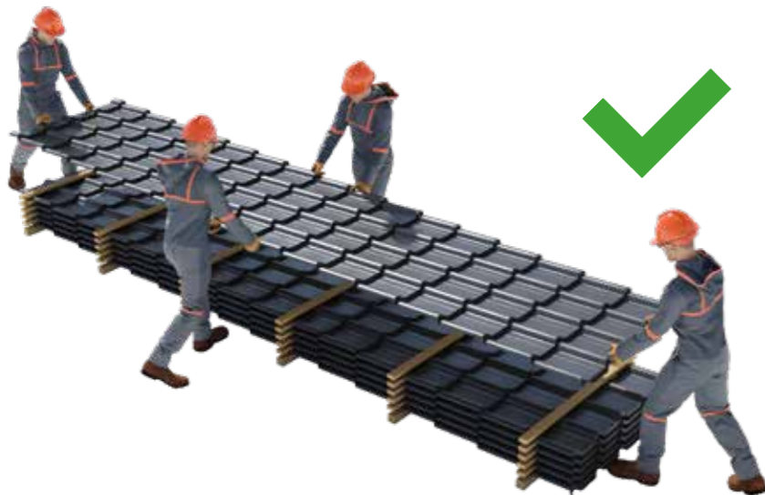
2 pav. Teisingas plieninių stogo čerpių transportavimo būdas.
