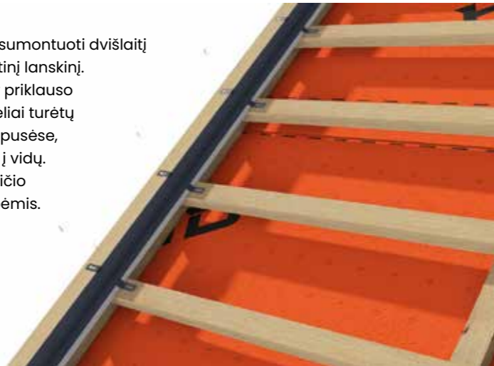
11 pav. Latakėlio montavimo būdas.
