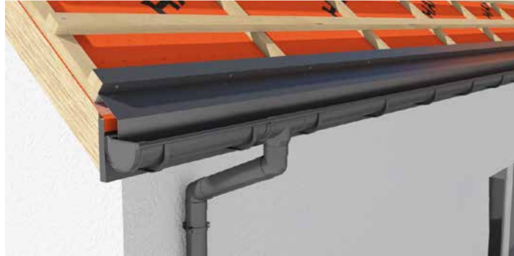
10 pav. Teisingas laštakio montavimas.
