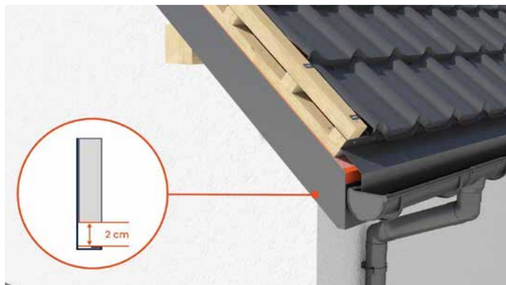
18 pav. Vėjalentės montavimas su 2 cm užlaida.
