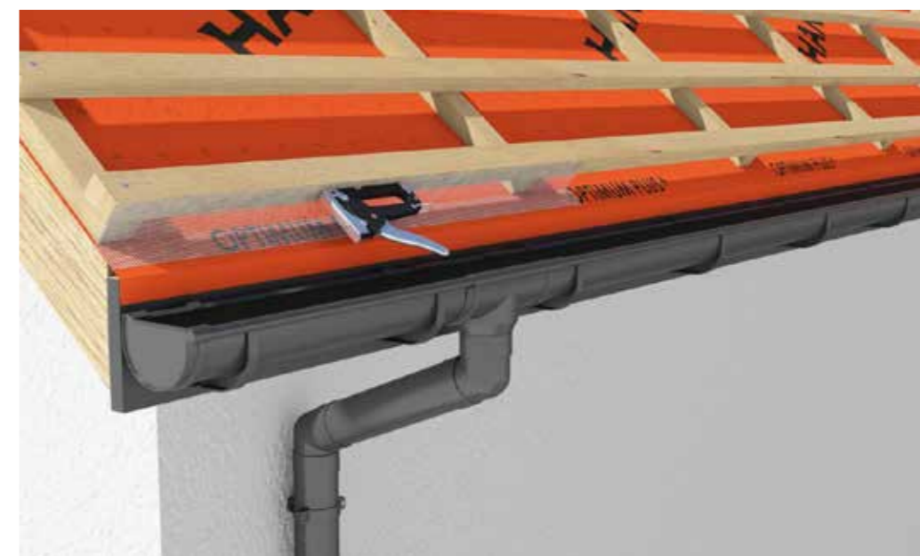
9 pav. Perforuoto tinklelio įrengimas stogo karnizo apsaugai nuo vabzdžių ir šiukšlių.
