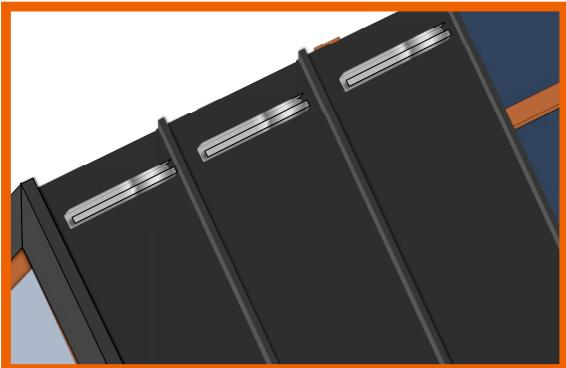
Pritvirtinus visas plokštes, tvirtinama kraigo lentjuostė ir vėjalentės. Tvirtinama paliekant ašinį atstumą kas 350 mm.
