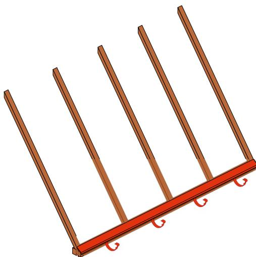
b) **Stogo karnizo lentos tvirtinimas** – tvirtinti pradėdama prisukant prie karnizo lentos gegnės, prie kurios tvirtinami skardos lankstiniai ir latakų kabliai. Paskiau tvirtinimo sraigtais arba vinimis tvirtinama latakų viršutinė juosta.
